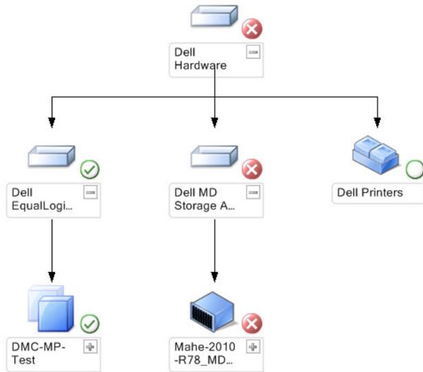
전체 다이어그램 보기에서는 OpsMgr 에서 관리하는 모든 Dell 장치의 그래픽 표시를 제공하고, 이를 통해 다이어그램에서 개별 장치와 해당 구성 요소의 상태를 확장하고 확인할 수 있습니다. 이 보기에 대한 루트 노드는 **Dell 하드웨어** 그룹입니다.
