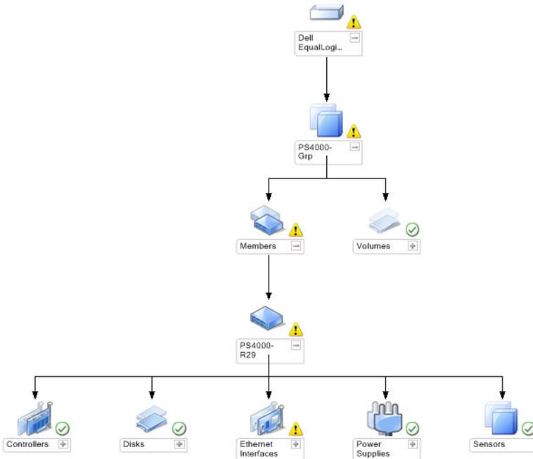
EqualLogic Diagram View(EqualLogic 다이어그램 보기)에서는 OpsMgr 에서 관리하는 모든 Dell EqualLogic 장치의 그래픽 표시를 제공하고, 이를 통해 다이어그램에서 개별 장치와 해당 구성 요소의 상태를 확장하고 확인할 수 있습니다. 이 보기에 대한 루트 노드는 **Dell EqualLogic** 그룹입니다.
